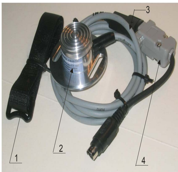
Rys-3: Zestaw czujnika nacisku na pedał hamulca
